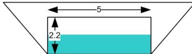
**Figure 2 exemple de dalot de franchissement sur un canal rectangulaire**
